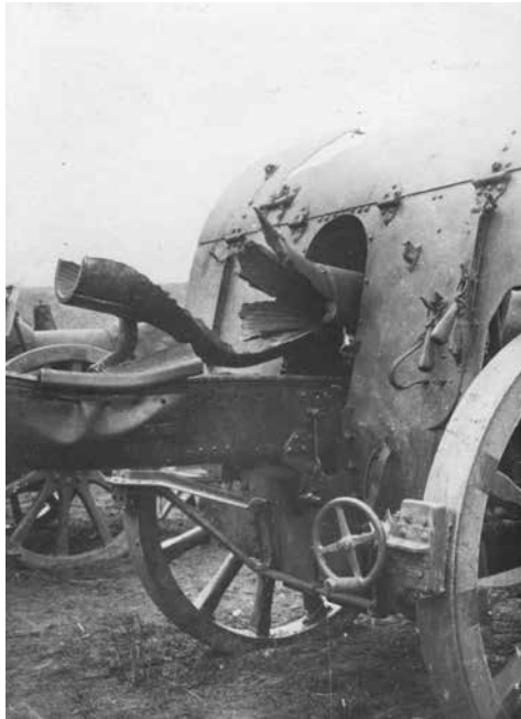
Durch Rohrkrepierer zerstörtes Artilleriegeschütz
